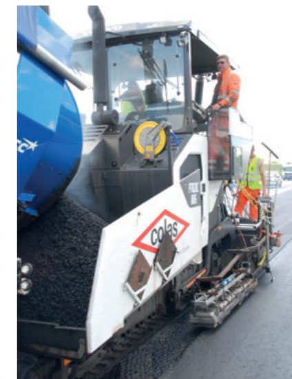
▲ Føreren har rigtig gode forhold i den nye asfaltudlægger. Der er monteret ekstra afskærmning mod vinden.
