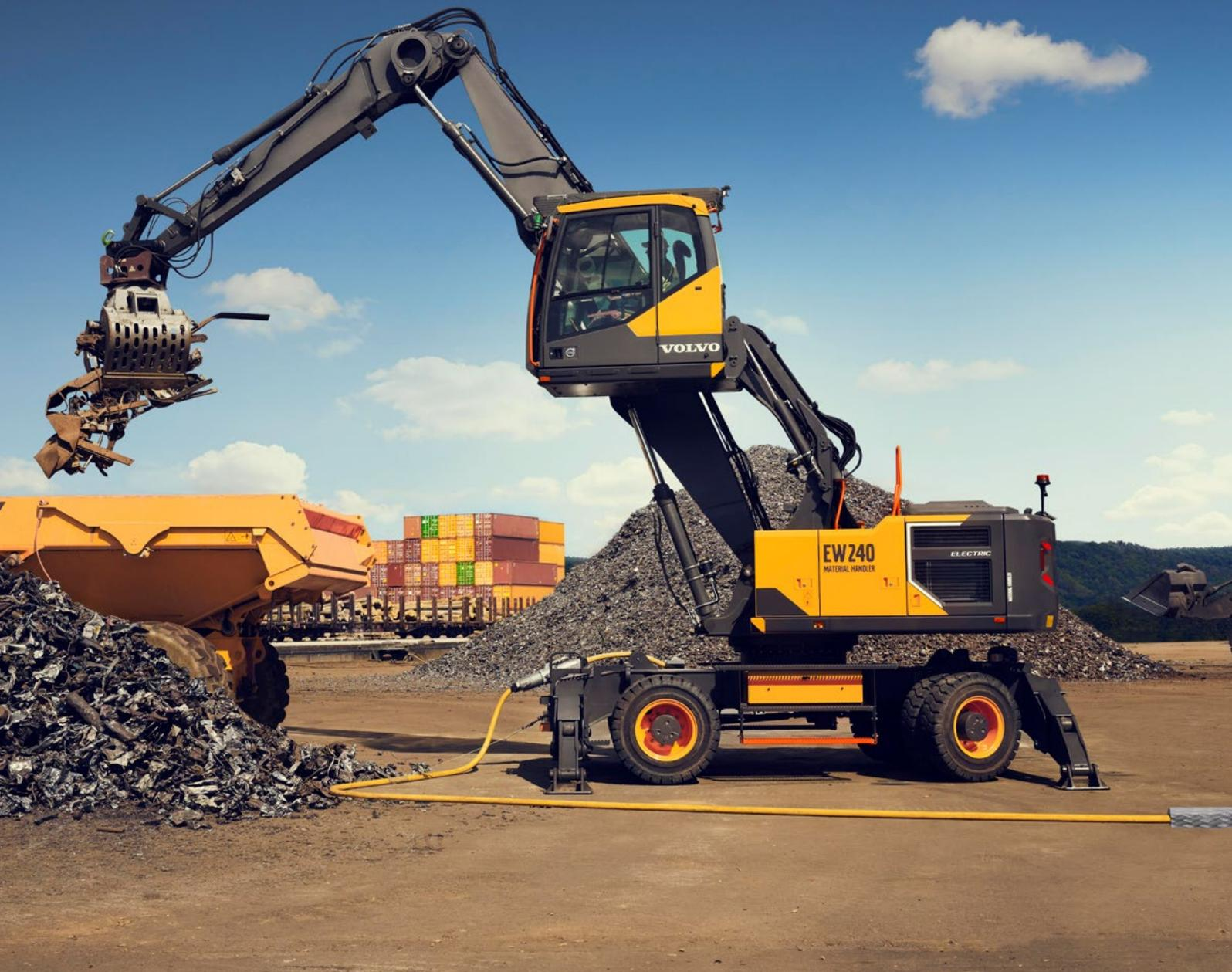
Pelles hydrauliques Volvo 26,5 t 90 kW
