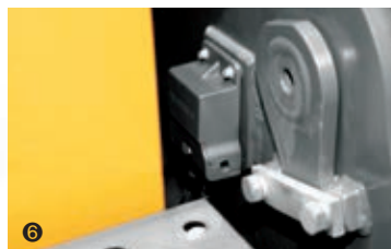
① 10인치 대형 전용 모니터 ② 전용 레버(L8 joystick) ③ 레이저 수신기 ④,⑤,⑥,⑦ 암, 붐, 프레임, 버킷 링크 IMU(각도센서)
