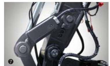
① 10인치 대형 전용 모니터 ② 전용 레버(L8 joystick) ③ 레이저 수신기 ④,⑤,⑥,⑦ 암, 붐, 프레임, 버킷 링크 IMU(각도센서)
