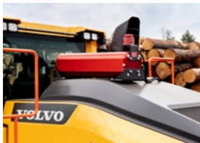
Sistema de supressão de incêndio
