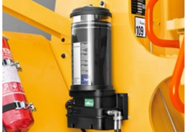
Enfriamiento externo de aceite de eje
