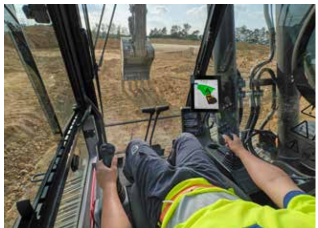
Aplicaciones Dig Assist, activado mediante Volvo Co-Pilot
