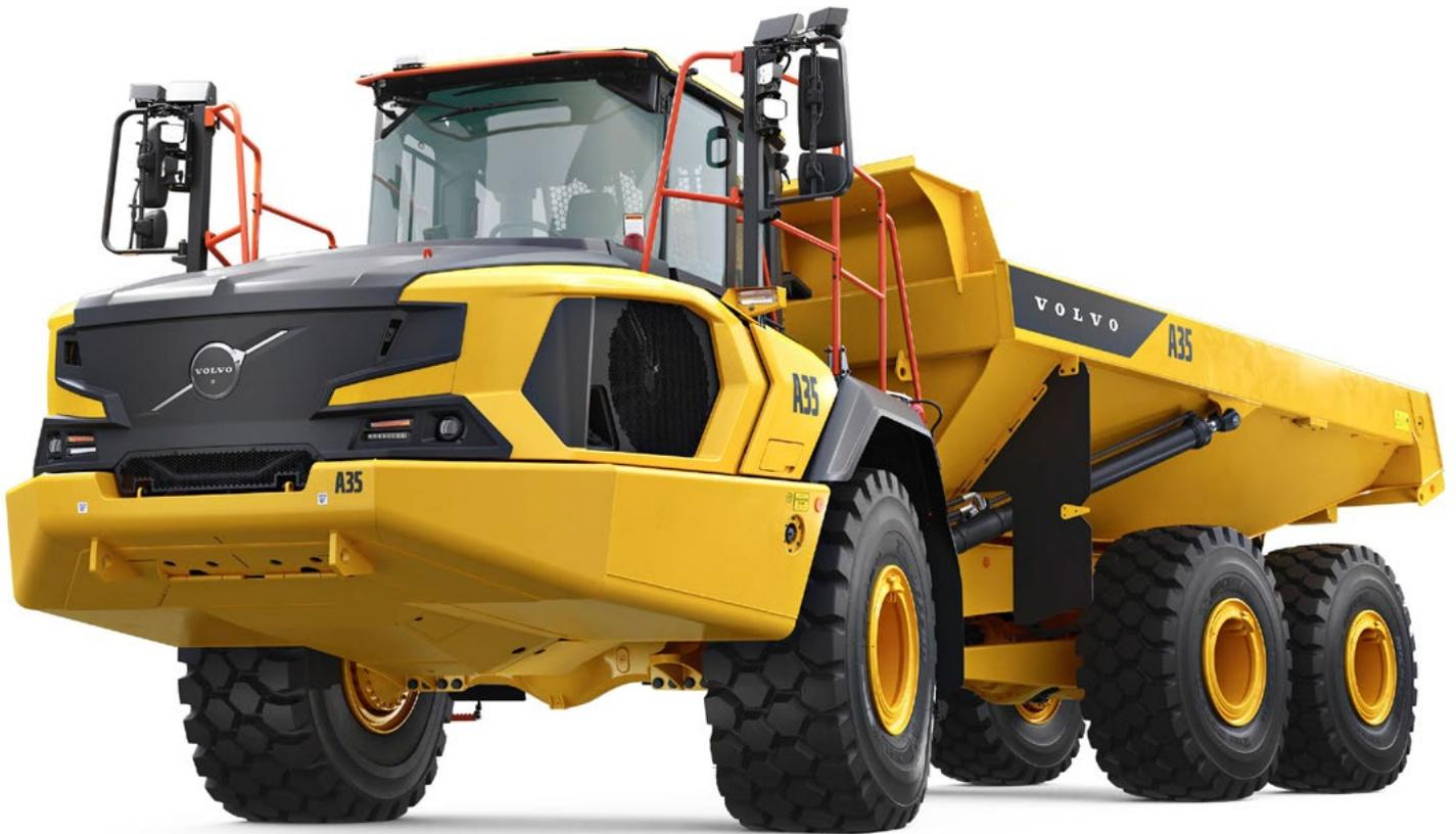
Volvo knickgelenkte Dumper 34,5 t 57 km/h 457 PS
